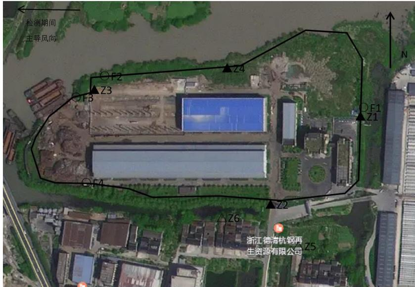
注：○-无组织废气采样点，▲-厂界噪声检测点，△-区域环境噪声检测点
