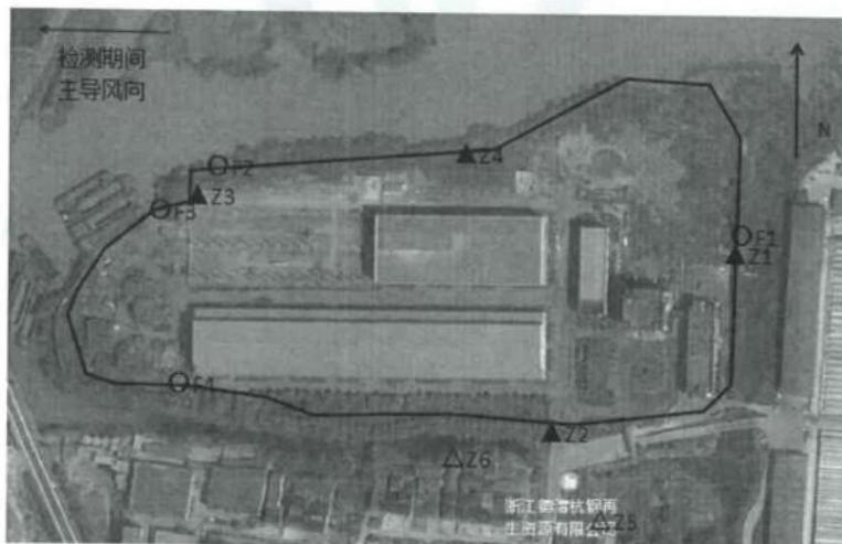
注: ○-无组织废气采样点, ▲-厂界噪声检测点, △-区域环境噪声检测点
