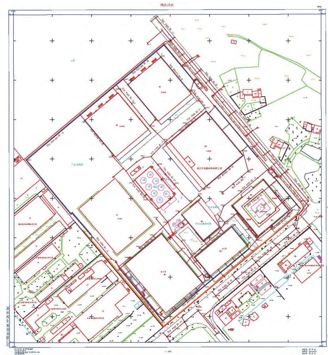
图 4.2-2 厂区污水管网分布图
