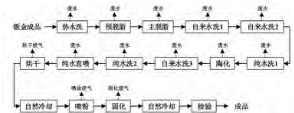
图 3.5-12 涂装线生产工艺流程图
