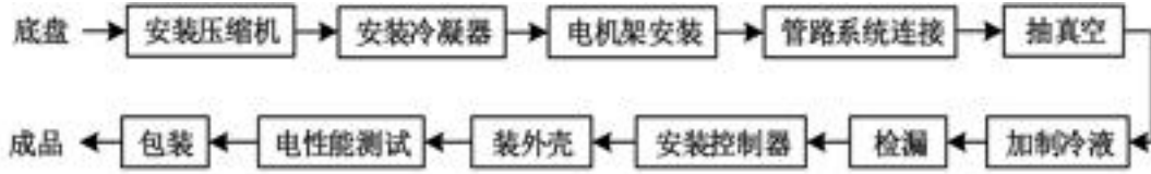
图 3.5-13 室内机总装工艺流程图
