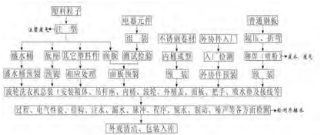
图 3.5-8 波轮洗衣机生产工艺流程图
