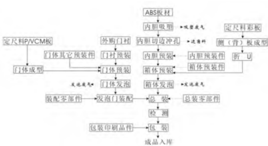
图 3.5-7 冰箱生产工艺流程图
