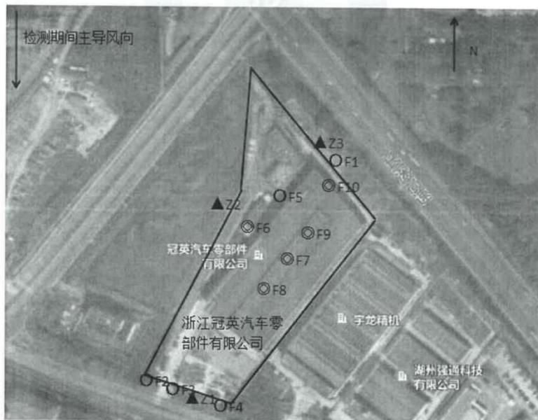
注: ○-无组织废气采样点, ⊙-有组织废气采样点, ▲-厂界噪声检测点
